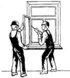
Рис. 40. Снятие оконных переплётов
