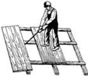
Рис. 32. Отрыв соседних с крайней досок
