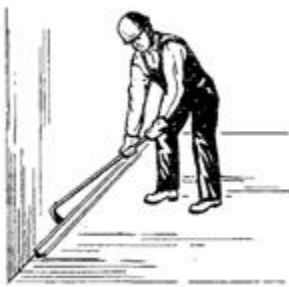
Рис. 30. Отрыв плинтуса от стены
